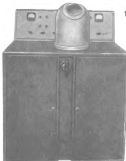
**кий универсальный УЭМВ-100В.** Разрешающая способность  $10 \text{ \AA}$ . Максимальное увеличение: визуальное  $1\,500\,000\times$ , фотографическое  $2\,000\,000\times$ .
