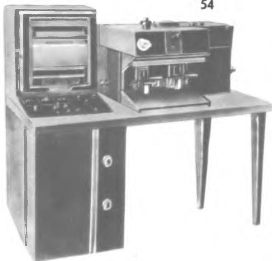
**43-46.** Осветитель УФП с ртутно-кварцевой лампой и пусковым устройством. Применяется в комплекте с горизонтальным фотометром ФМС-56.
