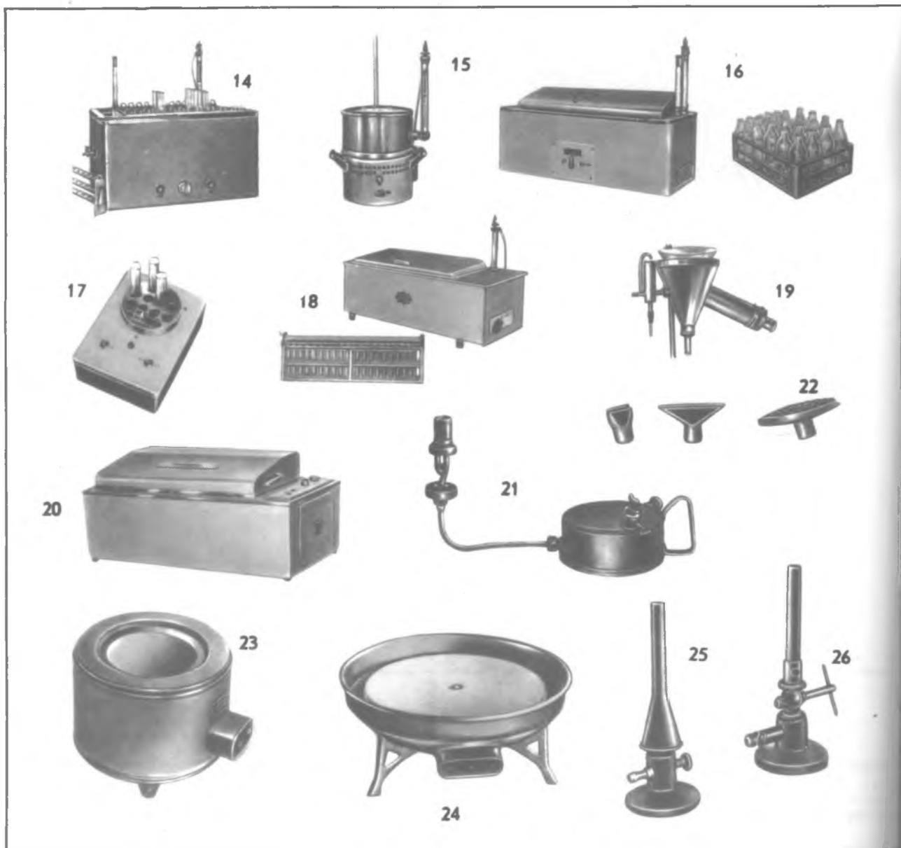
27-14. **Баня водяная для обеззараживания типа WR-225 для серологических работ.** Рабочая температура от 30 до 60°С. Емкость бани около 20 л. Потребляемая мощность 1,2 квт.
