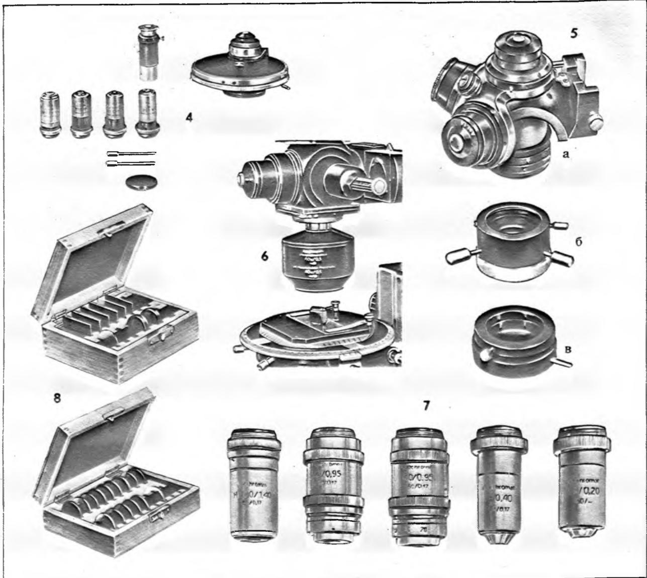
48-4. Фазовоконтрастное устройство Phv для микроскопа Ng. Поставляется с ахроматами комплектно. Выпускаются также фазово-контрастное устройство Phv к микроскопам типа Lg и Nu, в состав которого входят вспомогательный микроскоп, 4 фазовоконтрастных объектива, ахроматы 6,3/0,16; 16/0,32 Phv; 40/0,65 Phv; He 100/1,25 Phv и фазовый конденсор Phv.
