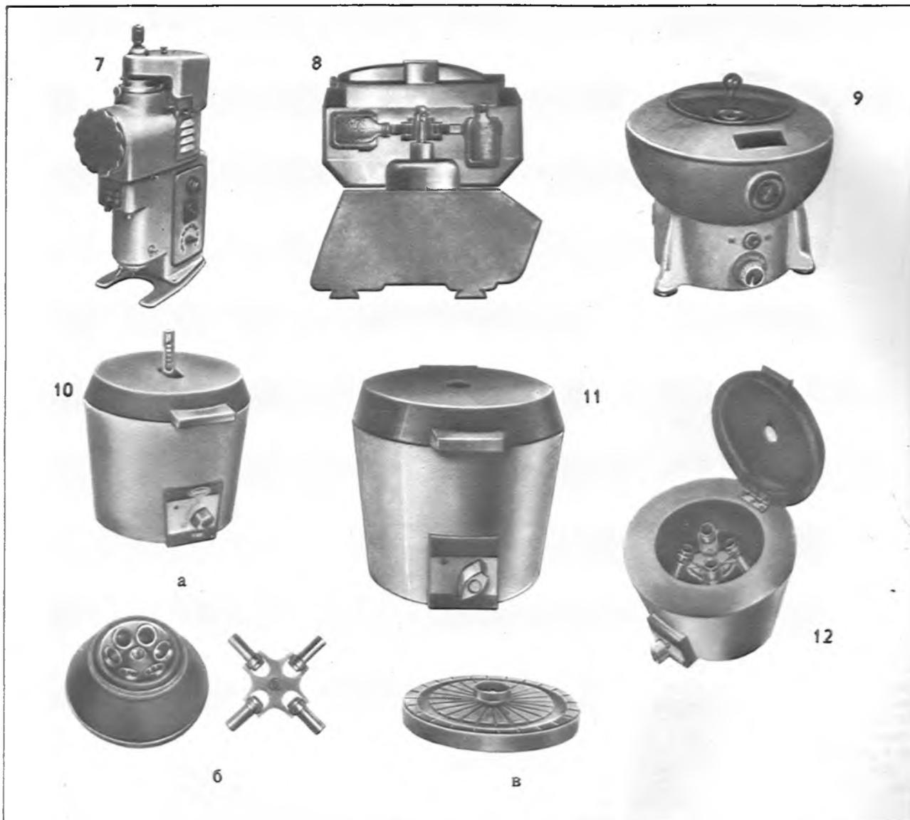
28-6. Суперцентрифуга лабораторная LZ-501. Максимальная емкость 200 мл. Число оборотов 30 000 в минуту. Потребляемая мощность 350 вт.
