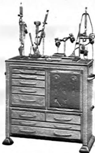
34-12. Полумикролаборатория органическая препаративная LG-101. В комплекте 102 стеклянных изделия. Поверхность стола 760×775 мм.
