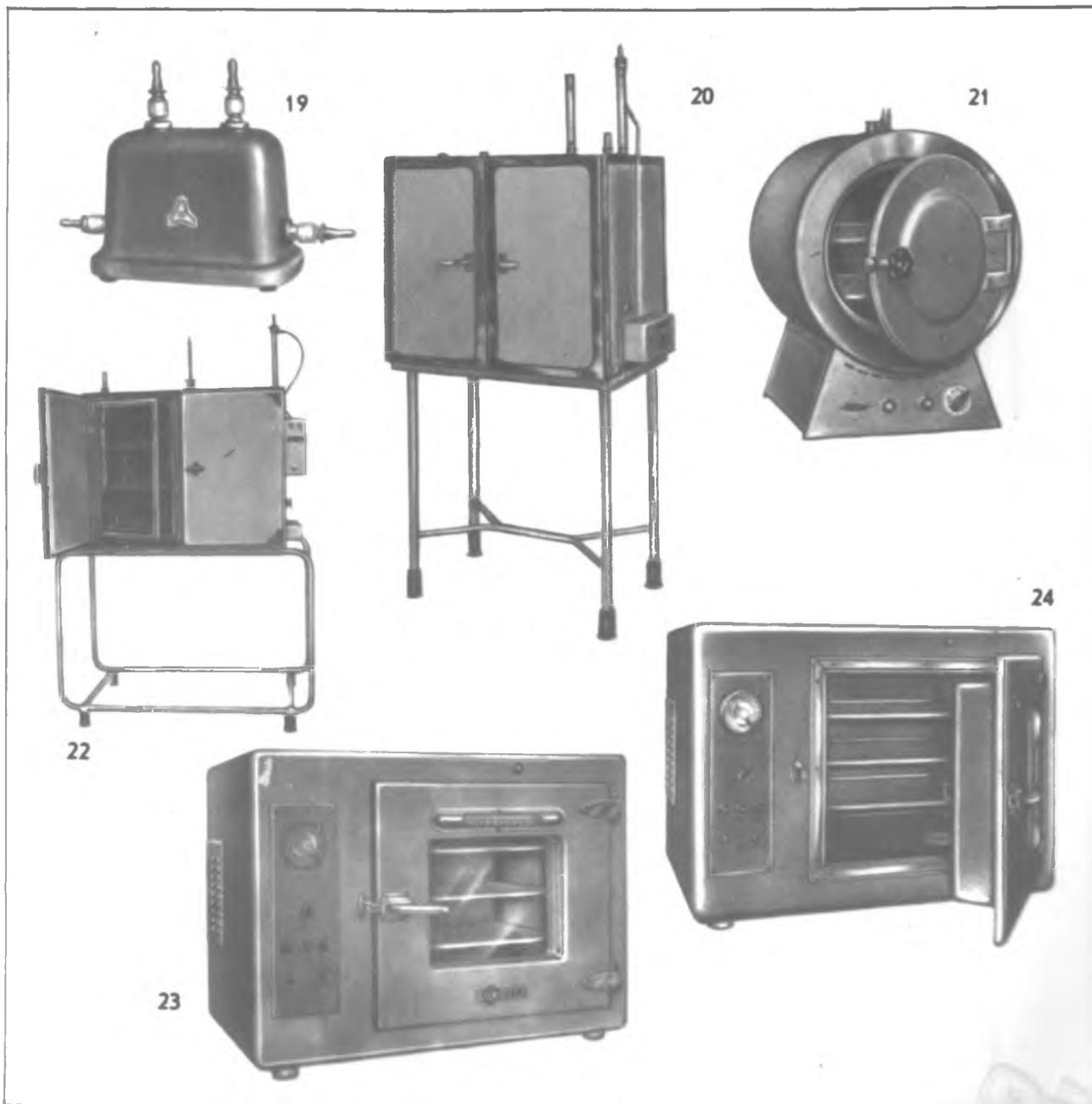
**38-20.** Шкафы инкубационные бактериологические «BRUWA» для микробиологических целей. Диапазон температур от 5 до 60° С с точностью  $\pm 0,2^\circ$  С. Выпускают шкафы «BRUWA» четырех типов, отличающихся по размерам и потребляемой мощности:
